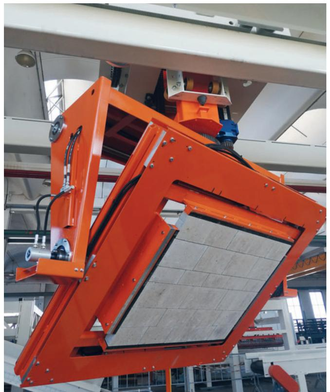
4-Achs-Greifer mit mechanischen Backen
