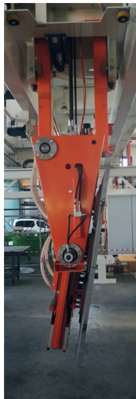
Cabezal de agarre vacuum con plano aspirante (para baldosas/tejas)
