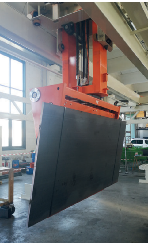
Cabezal de agarre vacuum con plano aspirante (para baldosas/tejas)
