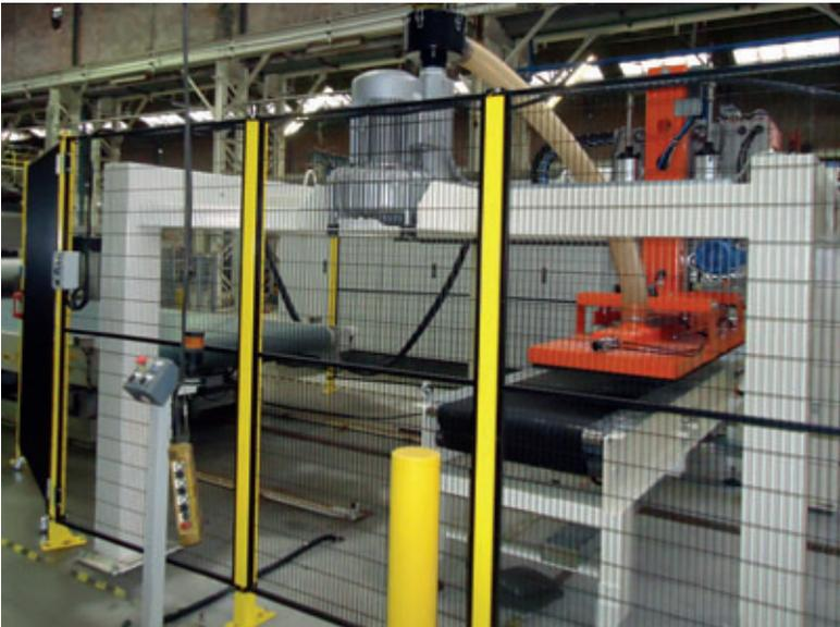
Fig. 2: Pinza con placa de vacío
