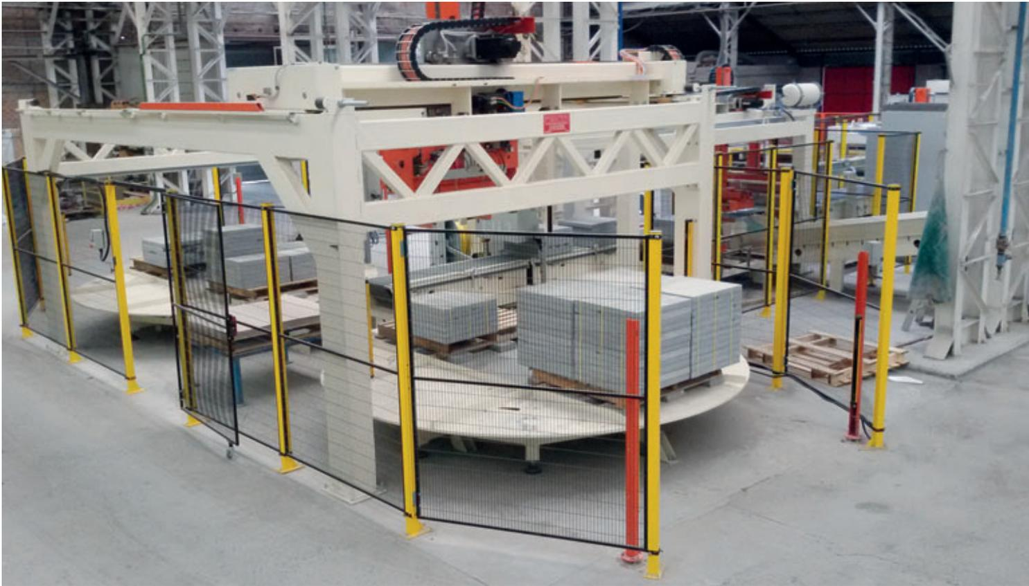
Fig. 6: Pinza de apilado de 5 ejes con 2 plataformas giratorias
