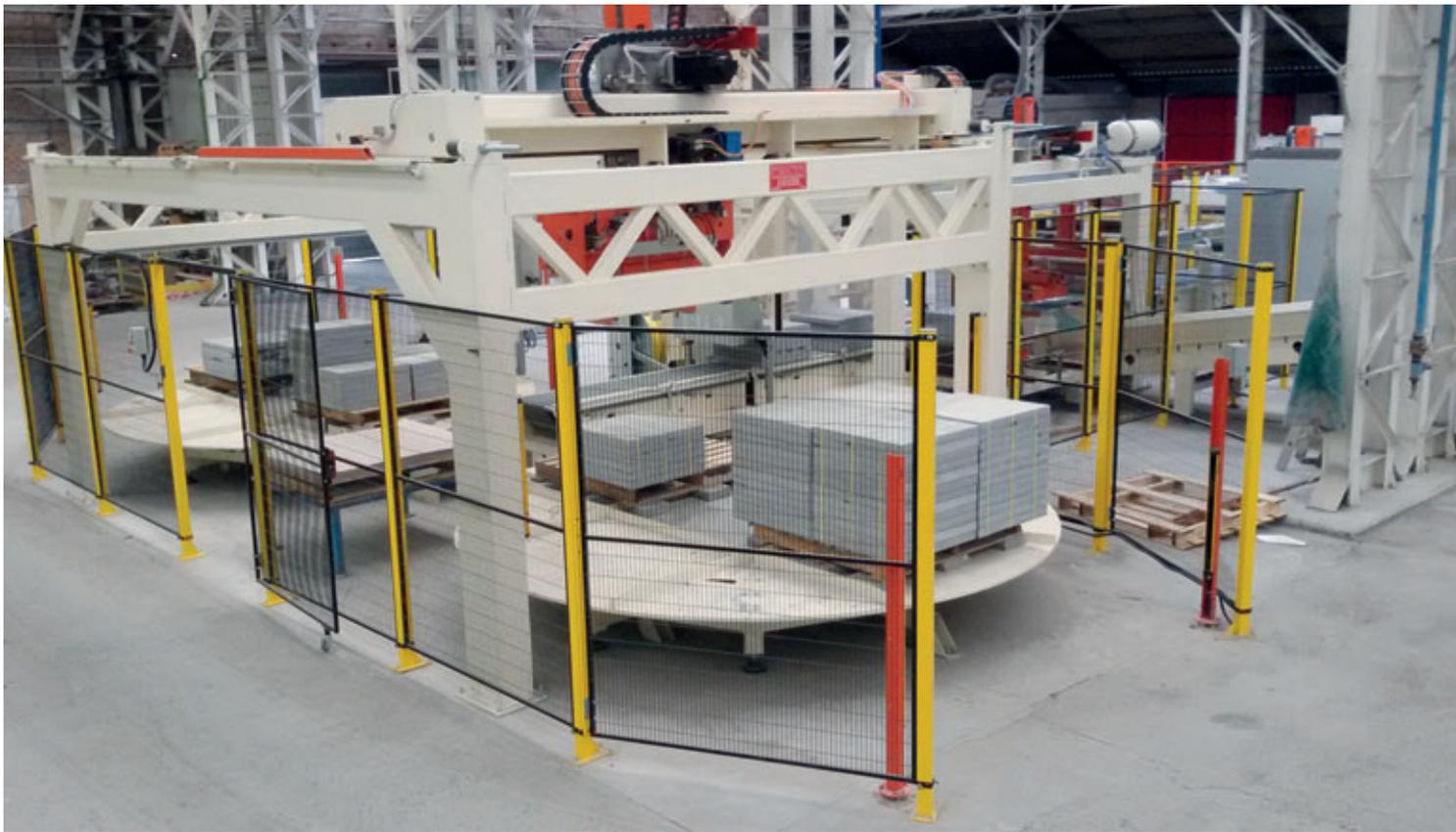
Fig. 6: Pince empileuse à 5 axes et 2 plateformes tournantes
