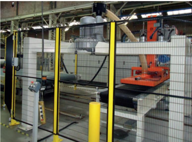
Fig. 2: Pince vacuum avec plan aspirant
