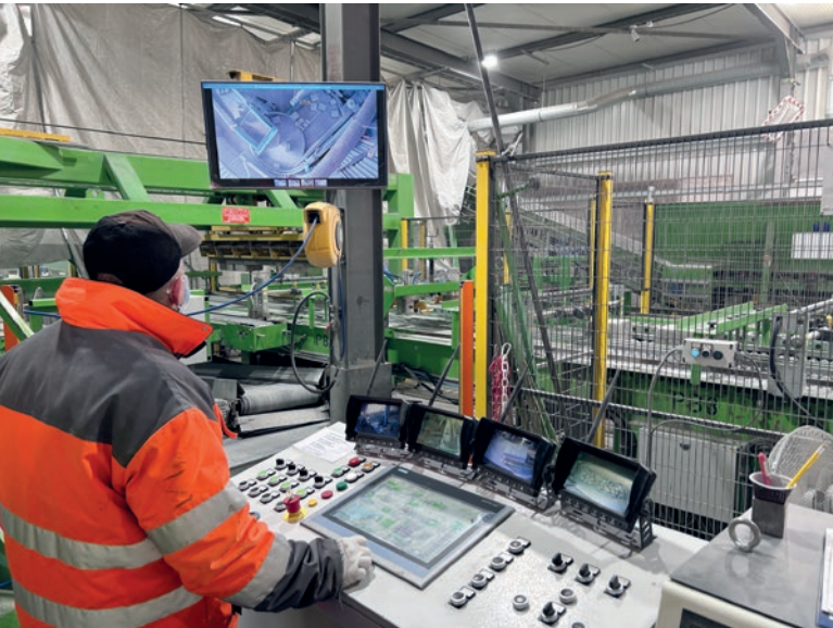
Alles im Blick: Bedienpult der Sortier- und Paketieranlage
