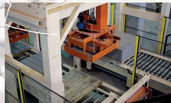
Im Anschluss an der Paketierung folgt der Steinpakettransport. Penta setzt verschiedene leistungsfähige Lösungen ein, die in optimaler Weise auf die Kundenbedürfnisse abgestimmt sind. In den Bereich des Transports von fertigen Steinpaketen kann Penta verschiedenen Verpackungssystemen (wie Umreifungsmaschine oder Stretchmaschine) oder auch Maschine zur Oberflächenschutz integrieren.
