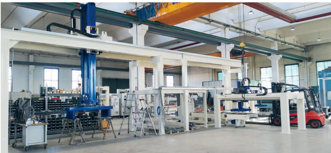
*Dispositivo de limpieza para bandejas de producción*
