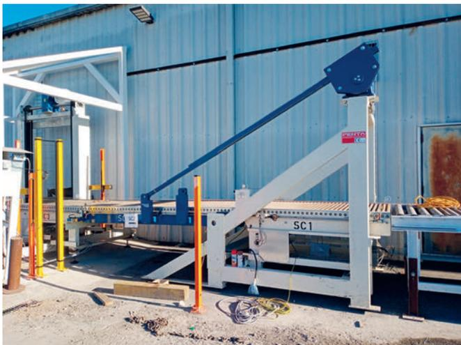
Convoyeur à rouleaux avec pont-levis
