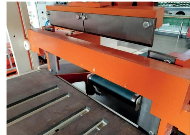
Die Bearbeitungsabfälle werden automatisch durch einen Band unterhalb der Klingen abtransportieren und in einem geeigneten Behälter gesammelt.
