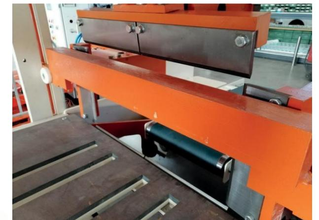
2 Les déchets de béton créés par le processus d'émoussement sont automatiquement éjectés et collectés sur la bande à déchets placée sous la position des lames.
