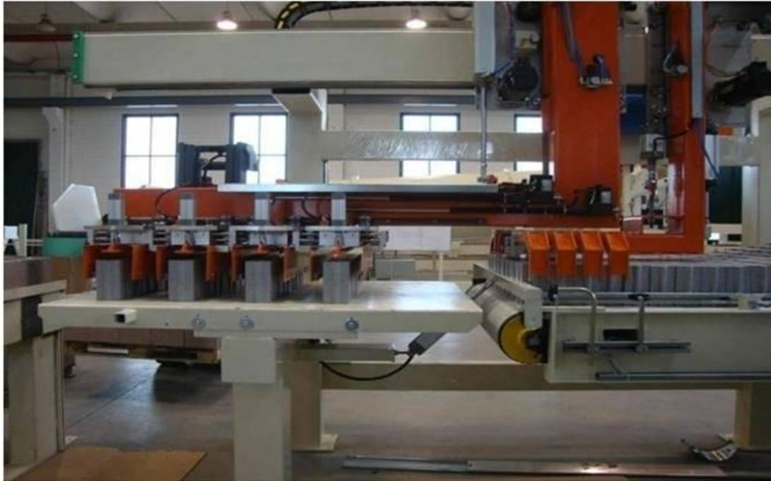
Système de vieillissement pour blocs
