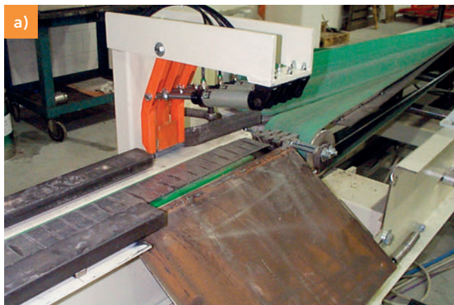
2003: Eine Caleidos-Anlage in den Niederlanden: Ein System zum Entfernen von beschädigten Betonsteinen, hinter der Zentrifuge angeordnet
