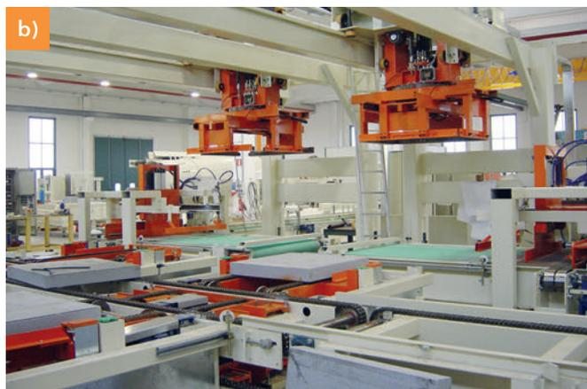
Sujetador de pilas con cuatro mordazas.
