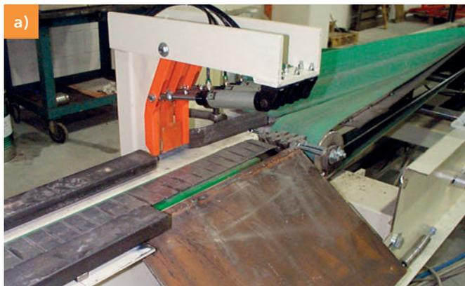
Más de 500 m<sup>2</sup>/hora se pueden procesar y empaquetar con sistemas de escaneo para retirar productos de hormigón no conformes. La instalación puede gestionar las cuatro líneas de producción simultáneamente o también todas las líneas de producción independientemente entre sí. Después de 20 años, la instalación sigue funcionando con la misma elevada capacidad.
