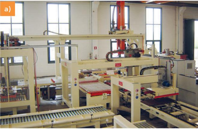
2007 Inglaterra: Transportador de rodillos, viga portante y sujetador.
