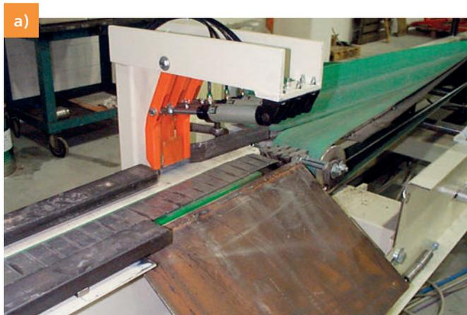
2003 : une installation Caleidos aux Pays-Bas : un système pour enlever les blocs de béton endommagés, placé derrière la centrifugeuse.
